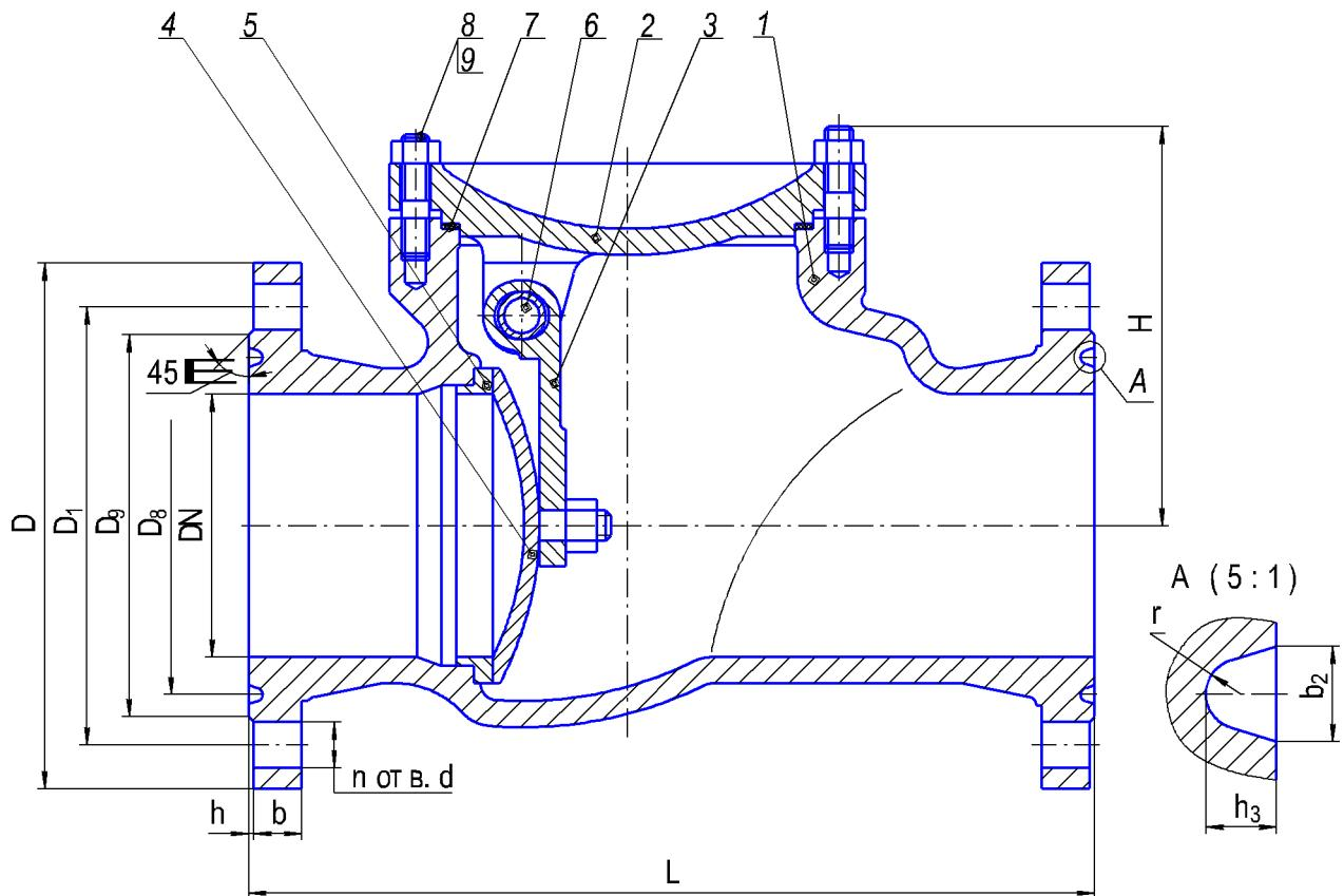
Присоединение к трубопроводу - фланцевое. Присоединительные размеры и размеры уплотнительных поверхностей фланцев по ГОСТ 12815-80, исполнение 7, ряд 2 (по умолчанию).
