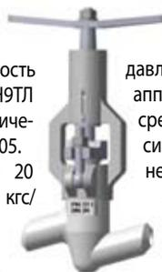
Предназначен для автоматического выпуска среды при повышении давления, вышеуказанного в резервуарах, аппаратах или трубопроводах. Рабочая среда — жидкие и газообразные, неагрессивные и малоагрессивные среды, нефть, нефтепродукты, углеводородные газы, аммиак, вода, пар, воздух, инертные газы. Настройка клапанов на требуемый диапазон рабочих давлений осуществляется при помощи сменных пружин. Соответствует ГОСТ 9789–75.
