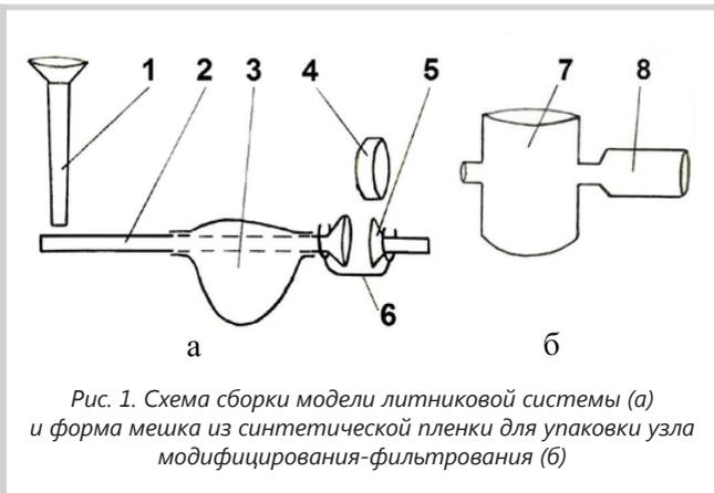
Рис. 1. Схема сборки модели литниковой системы (а) и форма мешка из синтетической пленки для упаковки узла модифицирования-фильтрации (б)
