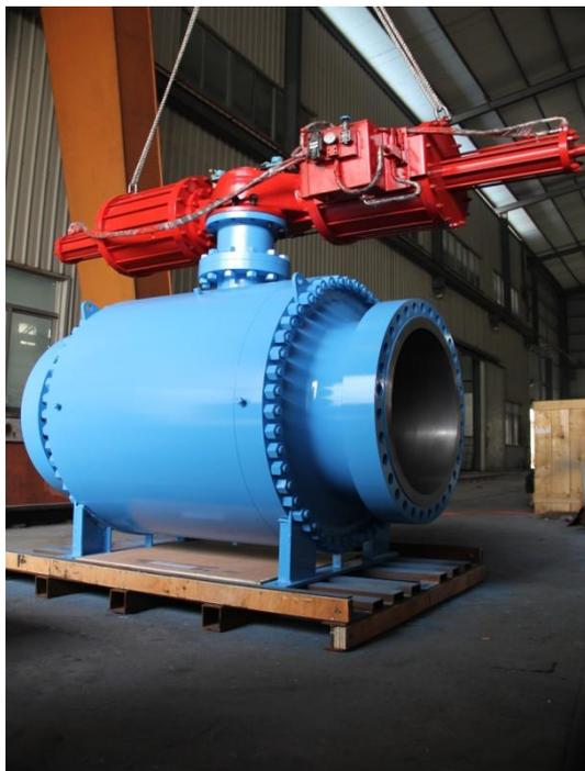
Кран шаровый с пробкой в опорах с боковой загрузкой шара.
