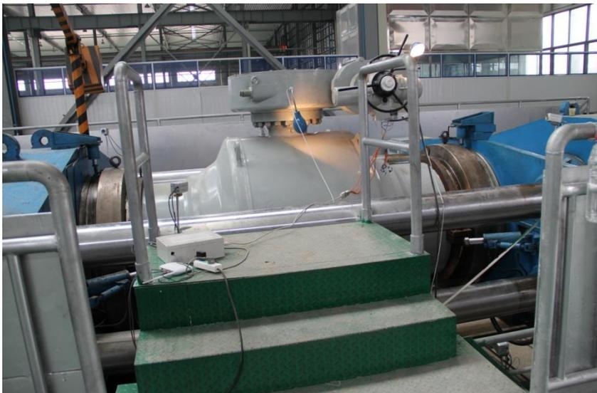
Продукция больших диаметров проходит испытания на Опрессовочных стендах для гидравлических испытаний с перепадом давления, что обеспечивает **герметичность класса А** и **срок эксплуатации в течении 30 лет**, как при надземной, так и подземной установке.
