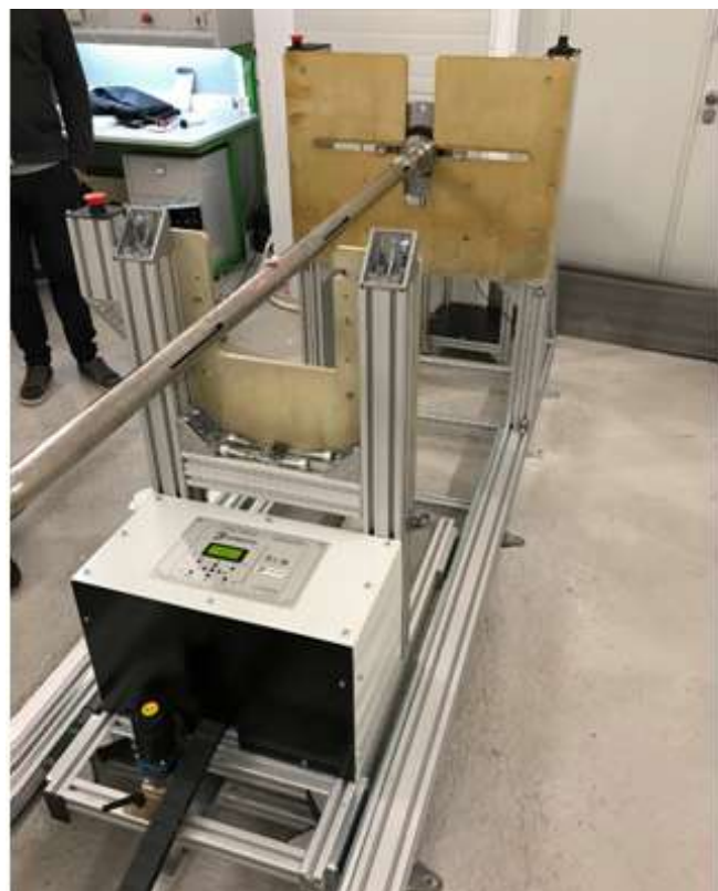
Рис. 20. Фрагмент стенда для поверки уровнемеров с установленным коаксиальным уровнемером
