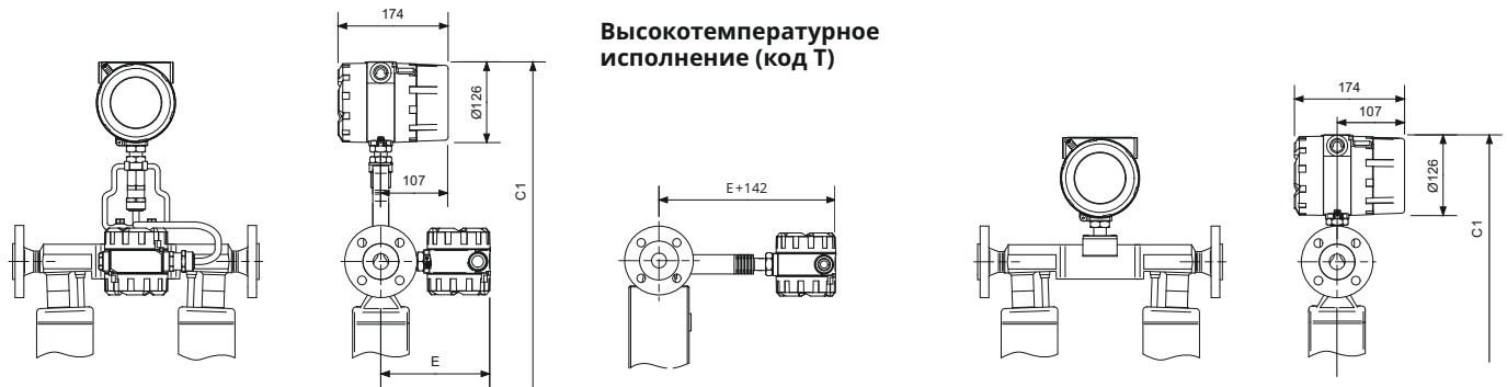
Рис. 10в. Габаритные размеры датчиков, исполнения I (по компоновке), S, Т (по температуре)
