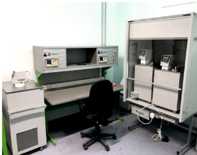
Рис. 15. Стенд поверки, калибровки и ремонта преобразователей температуры
