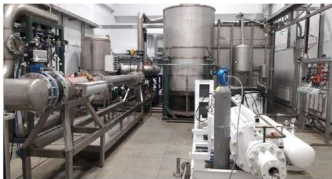
Рис. 24. Установка поверочная проливная расходом 600 м 3 /час
