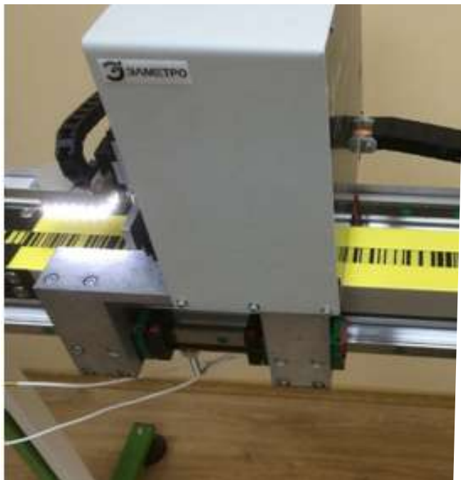
Рис. 23. Метрологическая установка для измерения длины ЭЛМЕТРО-ЛИЗА
