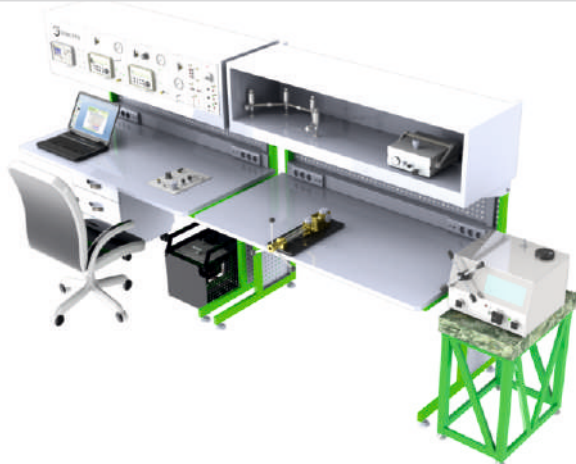
Рис. 6. Полуавтоматизированный метрологический стенд поверки, калибровки и ремонта манометров на базе калибратора давления ЭЛМЕТРО-Паскаль-02
