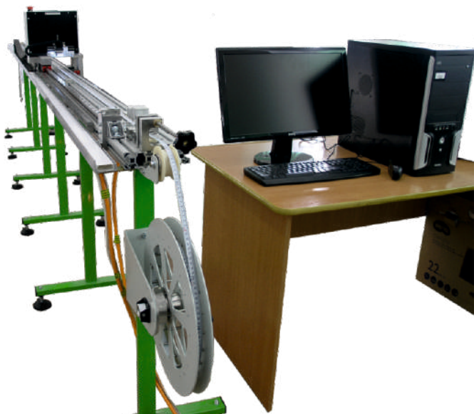
Рис. 22. Метрологическая установка для измерения длины ЭЛМЕТРО-ЛИЗА
