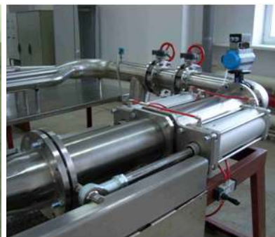
Рис. 31. Рабочий стол, и стол с системой стабилизации температуры, водоподготовки и очистки.
