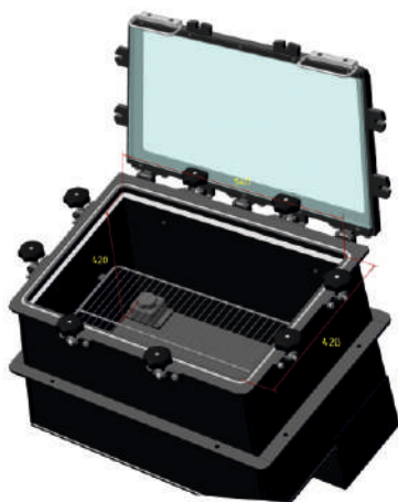
Рис. 10г. Большая камера для поверки большого числа барометров и метеостанций, содержит гермовводы с питанием от сети 220В и низковольтные разъёмы для подключения вспомогательной периферии (калибраторы, цифровые интерфейсы ПК, преобразователи)
