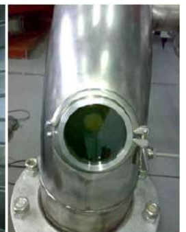
Рис. 32. Прозрачный участок трубопровода и системы очистки
