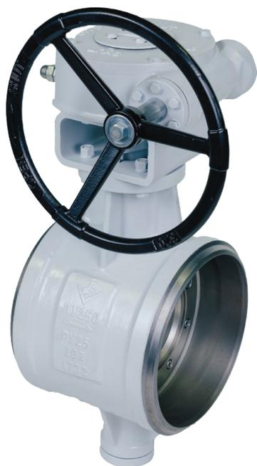
Основные задачи, решаемые конструкцией затвора с тремя смещениями (эксцентриситетами) — устранение трения за счет обеспечения полного отсутствия контакта между уплотнениями корпуса и диска в любой точке траектории рабочего хода диска.
