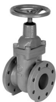
Zasuwy pierścieniowe kołnierzowe krótkie F4 wykonane na pierścieniach mosiężnych nr 2110
