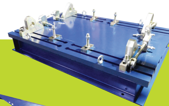
Постамент для разборки-сборки трубопроводной арматуры DN 300-600мм
