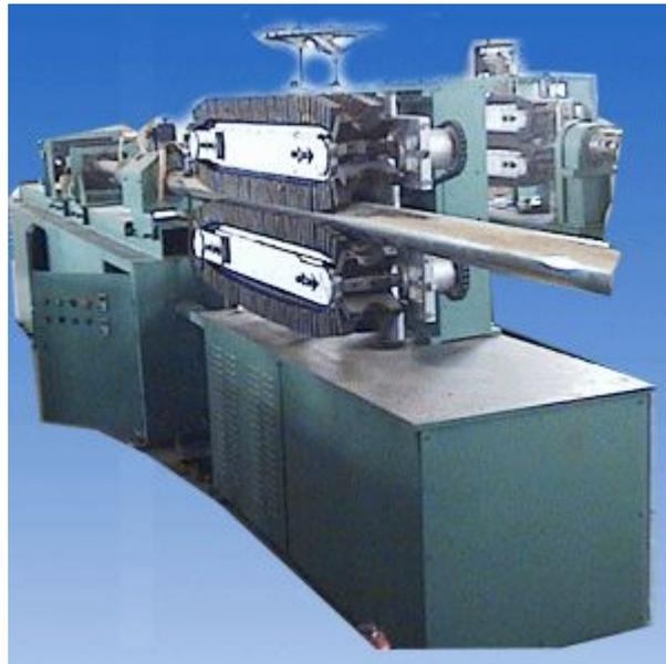
1). Диаметр сваряемой трубы: 8~150mm and DN150-400mm
