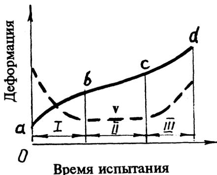
Рис. 2.3.3. Типичная кривая ползучести при растяжении
