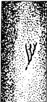
Рис. 3.2.20. Рванины на поверхности стальной заготовки
