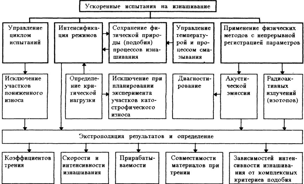
Рис. 2.3.43. Способы ускорения испытаний
