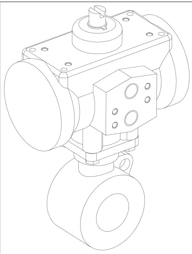
Рис. 12. Шаровой клапан MARS.
